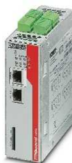
Router mit intelligenter Firewall und VPN
