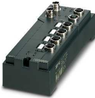
4 Temperatureingänge für resistive Sensoren
