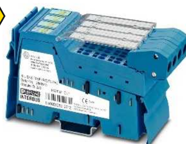
4 wählbare Temperatureingänge, RTD oder TC
