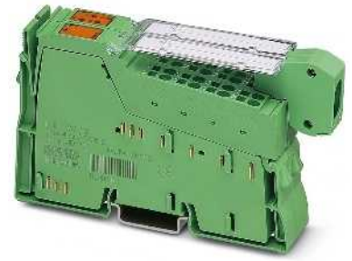
Pulsweitenmodulation, Frequenzgenerator oder Puls-/Richtungssignalausgabe
