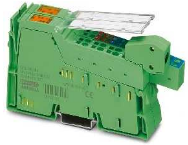
Eingang für Inkremental-Encoder mit Rechtecksignal (symmetrisch oder asymmetrisch)
