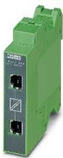
Übertragungsraten bis 100 MBit/s, zweimal RJ45-Anschluss
