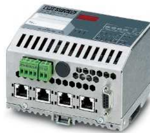
PROFINET-PROFIBUS-Proxy für PC WORX-Steuerungssysteme
