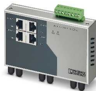
4 RJ45-Ports und 3 LWL-Ports
