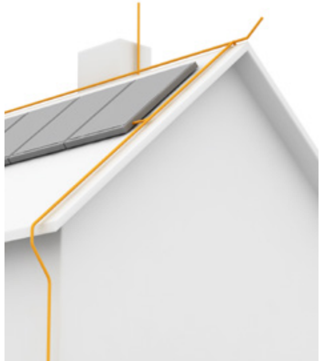
Direkter Anschluss der PV-Montagegestelle an das Blitzschutzsystem
