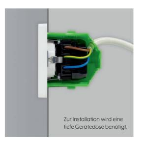
Die Steckdosen eignen sich ideal für die Nachrüstung. Dazu werden einfach der vorhandene Steckdosen-Einsatz und die Abdeckung ausgetauscht. In Mehrfachkombinationen sind auch einzelne Elemente nachrüstbar. Der Einbau ist in allen üblichen 55 x 55 Schalterprogrammen wie der Serie A und auch in
