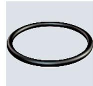
O-Dichtringe, geeignet als Anschlussgewinde-Dichtringe für alle Kabelverschraubungen aus Kunststoff und Messing mit PG-Anschlussgewinde nach DIN EN 60423 bzw. ISO 68. Die Ringe können unverlierbar vormontiert werden.
