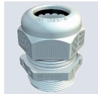
Die schnellste und bequemste Art mit Kabelverschraubungen an Kabelabzweiggästen und Gehäusen für Zugentlastung und Dichtigkeit zu sorgen: die bewährte V-TEC VM Kabelverschraubungen von OBO. Mit der integrierten Dichtlippe und speziellen OBO Lamellentechnik wird die Schutzklasse IP68 erreicht. Zugentlastung und Dichtigkeit sind geprüft nach DIN EN 62444.
