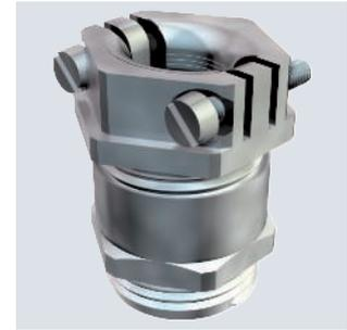
Kabelverschraubung mit zentrisch wirkender Querbügel-Zugentlastung in der Druckschraube, Biegeschutz beweglicher Leitungen durch stark gerundete Druckschraube.
