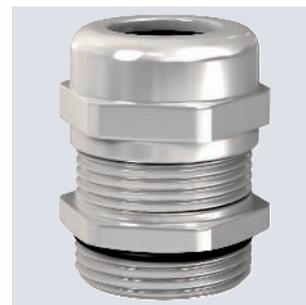
Robuste EMV Kabelverschraubung mit metrischem Anschlussgewinde nach IEC 423 in Hutmutterbauart für hohe Dichtigkeitsansprüche. Die Kontaktierung zwischen Verschraubung und Schirmgeflecht erfolgt über eine Kontaktfeder. Zugentlastung, Verdrehenschutz und Dichtigkeit über den gesamten Spannungsbereich. Dichttring aus Neopren. Klemmeinsatz aus Polyamid. Mit vormontiertem O-Dichtring am Anschlussgewinde, VDE-geprüft nach DIN EN 50262, Schutzart IP68 bei 5 bar/1 h.
