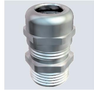
Kabelverschraubung in Hutmutterbauart mit großem Dichtbereich sowie Zugentlastung und Verdreherschutz für hohe Dichtigkeitsansprüche mit langem PG-Anschlussgewinde nach DIN 40430, für dickere Gehäusewandstärken in Verbindung mit Gegenmutter.
