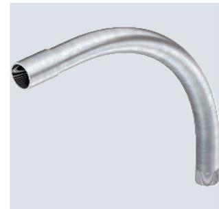
90°-Bogen für Elektroinstallationsrohre nach EN 61386-1 mit Gewindeenden nach DIN EN 60423. Mit gratfreier Innenwand. Pro Rohrbogen ist bereits eine Verbindungsmuffe aufgeschraubt.
