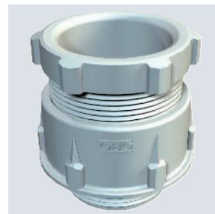
Standard-Kabelverschraubung, Form A nach DIN 46320 mit einfachem Dichtring aus NR/SBR mit metrischem Anschlussgewinde nach IEC 423.
