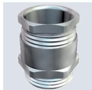
Kabelverschraubung mit Sechskant-Zwischenstutzen, Form C4 nach DIN 46320 mit metrischem Anschlussgewinde nach DIN EN 60423 bzw. ISO 68. Druckringe Stahl, galvanisch verzinkt und transparent passiviert. Dichtring aus NR/SBR.
