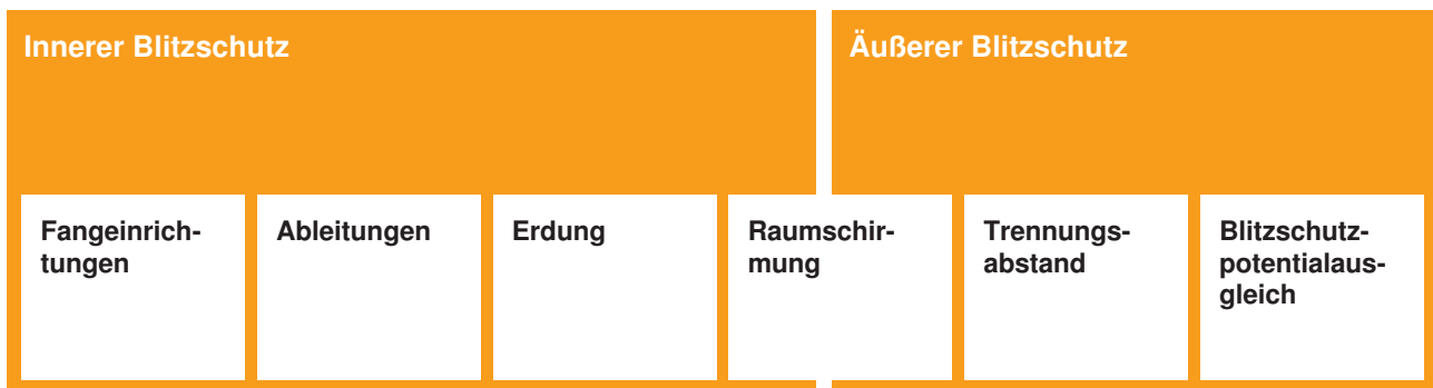
Systeme des äußeren und inneren Blitzschutzes
