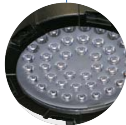
LED-Panel mit einzelnen Optiken je LED
