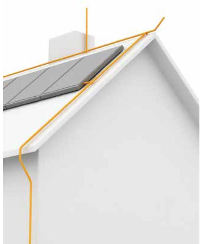
Direkter Anschluss der PV-Montagegestelle an das Blitzschutzsystem
