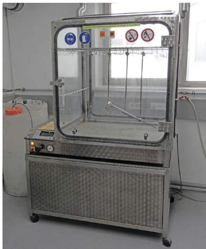
Bild 2: Prüfungen mit dem Kesternichgerät.
