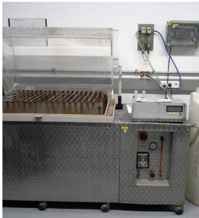
Bild 1: Prüfungen mit einer Salzsprühtruhe.
