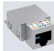
Anschlussmodul Kat. 6 geschirmt, mit einem RJ45-Steckplatz. Inklusive einer EMV-Schirmhaube, einer Staubschutzkappe, einem Kabelbinder und einer Montageanleitung. Geeignet für den Einbau in Datentechnikträger Typ DTG-2RM und DTS-2RM.
