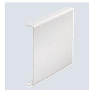
Oberteil aus Aluminium zum Verschließen der Rapid GA Geräteinbaukanäle und ISS Installationssäulen mit 76,5er Systemöffnung. Der feste Sitz des Oberteils und die elektrische Kontaktierung zum Kanal-/Säulenunterteil ist durch die Rastklammern Typ RKV3V garantiert. In jeder Lieferlänge (100 mm) sind 2 Rastklammern vormontiert.
