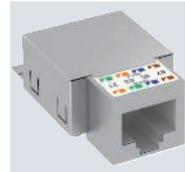
Anschlussmodul Kat. 5e geschirmt, mit einem RJ45-Steckplatz. Inklusive einer EMV-Schirmhaube, einer Staubschutzkappe, einem Kabelbinder und einer Montageanleitung. Geeignet für den Einbau in Datentechnikträger Typ DTG-2RM und DTS-2RM.
