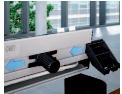
Vorbereitung der Deskbox-Befestigung Die Befestigungselemente der Befestigungszwingen werden seitlich in das Gehäuseprofil eingesetzt. Optional ist ebenfalls ein Flexkanalhalter montierbar.
