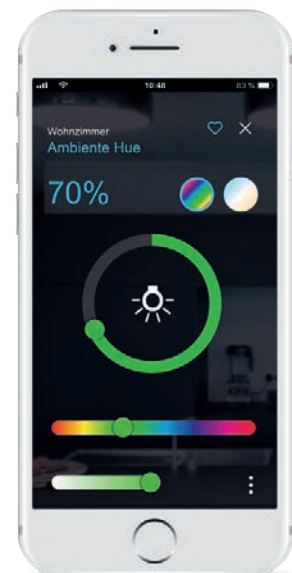
Langklick zur Detailsteuerung Hier: Dimmwert, W-Farbwahl und Farbtemperatur-Einstellung für DALI oder Philips-Hue-Lampen.
