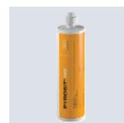
PYROSIT® NG 2-Komponenten-Brandschutzschaum in Kartusche, inklusive 2 Mischrohren. Zur Erstellung von Kabel- und Kombiabstottungen; Verarbeitung der Koaxialkartusche 5:1 unbedingt mit Kartuschenpistolen FBS-PH oder FBS-PA. In trockenen, frostfreien Räumen können die Kartuschen bei Temperaturen von +5°C bis +30°C bis zu 12 Monate verschlossen und stehend gelagert werden.
