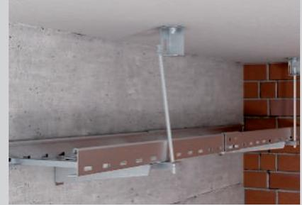
Deckenbefestigung der Gewindestangen mit Brandschutzbügel.
