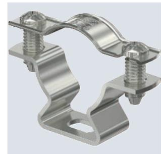
Abstandschelle zur Montage von Röhren und Kabeln an Wand, Decke und Boden. Mit selbstsicherndem Oberteil. Befestigung über Langloch. Zugelassen für den Funktionserhalt nach DIN 4102 Teil 12, Funktionserhaltklassen E 30 bis E 90.
