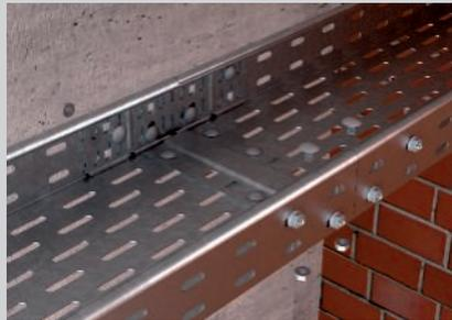
Längsverbinder und Stoßstellenleiste mit Flachrundschrauben befestigen.
