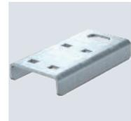
Das Anschlussbauteil ist die Verbindung der Gewindestangensicherung mit dem Abhängesystem für die Verlegearten mit Kabelrinnen zum Funktionserhalt nach DIN 4102 Teil 12. Inklusive Schrauben und Muttern.
