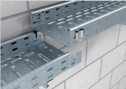
Erstellen der Längsverbindung durch Ineinanderstecken der Kabelrinnen.
