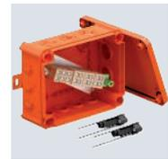
Kabelabzweigkasten mit zwei Sicherungshaltern und weichen Einsteckdichtungen. Ausreichender Verdrahtungsraum durch diagonal angeordnete Anschlusseinheit mit komplett vormontierten hochtemperaturbeständigen Keramikklemmen. Grün-gelb gekennzeichnete Schutzleiterklemme. Befestigung an gut zugänglichen Außenlaschen. Zugelassen für Kabelanlagen mit elektrischem Funktionserhalt nach DIN 4102 Teil 12 mit den Klassen E30, E60 und E90. Keramikklemmen wurden nach DIN EN 60998-2-1:2004 geprüft.
