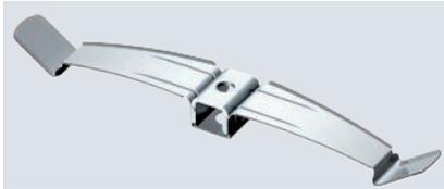
Die Kabelklammer aus Metall ist halogen- und brandlastfrei und bietet auch im Brandfall hohe mechanische Standfestigkeit. Die Kabelklammer ist als kabelspezifische Variante für den elektrischen Funktionserhalt gem. DIN 4102 Teil 12 zugelassen. Das Distanzstück 2033 D 15 x 3 G (separat zu bestellen) vergrößert bei Kabelklammern die Klemmhöhe von 10 auf 13 mm. Die Kabelklammer eignet sich zur brandsicheren Montage oberhalb abgehängter Brandschutzdecken nach DIN 4102.
