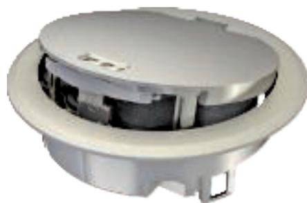
Klappdeckel mit Rastschieber für Bodensteckdose GES R2 zum direkten Einbau in die Installationsdose MT R2. Im geschlossenen Zustand erfüllt die Bodensteckdose die Anforderung der EN 50085-2-2 an nass gepflegte Böden.
