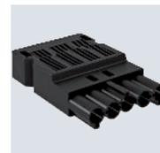
Steckerteil 5-polig, Typ GST18i mit Schraubanschluss für Leitungen 1,5 - 2,5 mm<sup>2</sup>, ein- und feindrätig, mit Zugentlastung, ein Anschluss pro Pol, unmontiert, für Leitungen H05VV (Ø 9,5 - 13,5) NYM und (Ø 10,5 - 13,5 mm), verriegelbar, gemäß Zugentlastung nach VDE 0628 ist eine Verriegelung vorzusehen, 250 V, 16 A.
