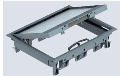
Geräteeinsatz mit Rastschieber für bis zu 9 Modul 45-Einzelgeräte in 3 Universalträger UT3, Einsatz in Kanalsystemen und Systemböden im Innenbereich.
