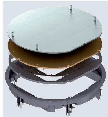
Zugdoseneinsatz zum Blindverschluss einer runden Montageöffnung der Nenngröße R9 in Kanalsystemen sowie in Doppel- und Hohlböden im Innenbereich. Mit Universalbefestigungswinkel. Teppichschutzrahmen aus Polyamid. Bodenbelagstärke max. 12 mm.
