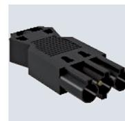
Steckerteil 3-polig, Typ GST18i mit Schraubanschluss, geringe Bauhöhe (kein Steckplatzverlust in Kombination mit Verteilerblöcken), für Querschnitt 0,75 - 2,5 mm<sup>2</sup>, ein- und feindrätige Leiter ohne Aderendhülse anschließbar, für Leitungsdurchmesser von 6,5 - 10,5 mm (H05VV, NYM), unmontiert mit Zugentlastung, vor Ort konfektionierbar, 250 V, 16 A.
