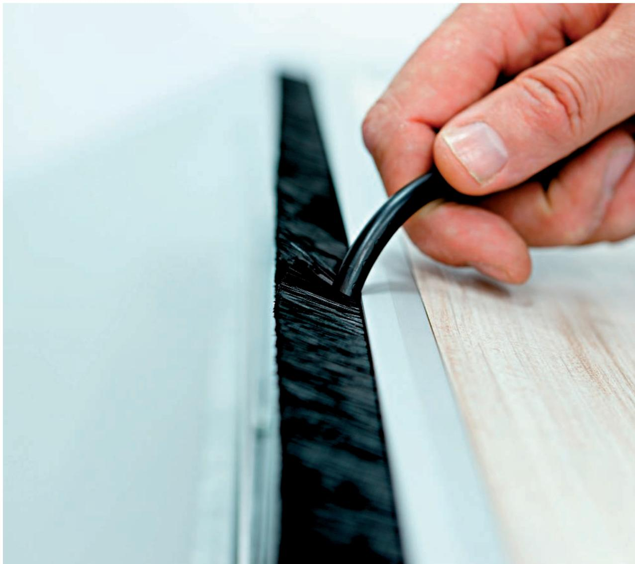
Das Bürstenleisten-Kanalsystem OKB verläuft entlang der Wand und hat über seine gesamte Länge hinweg eine Öffnung. Eine Bürstenleiste verdeckt diese Öffnung und dient als optisch ansprechender Sicht- und Staubschutz. Die Kabel können an beliebiger Stelle aus dem Kanal geführt werden. Das System lässt sich jederzeit an die jeweilige Raumsituation anpassen: Die fertig montierten Kanäle können problemlos geöffnet und
