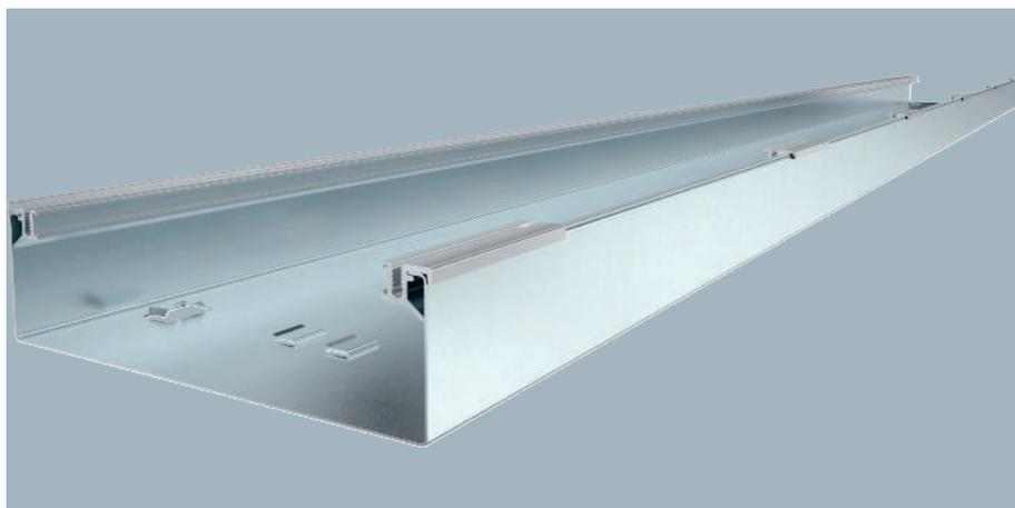
Aufflur-Installationskanal-Unterteil, 1-zügig, für Blind-/Montagedeckel mit einseitiger Abschrägung, mit aufsteckbaren Aluminium-Seitenprofilen zum Auflagen und Befestigen der Kanaldeckel, Bodenwanne mit Haltetaschen für max. 2 einsteckbare, selbstkontaktierende Trennsteg und Prägung für Schutzleiteranschlusswinkel. Kanalhöhe geeignet zum Einbau von Geräteeinbauten der Nenngröße 2.
