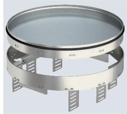
Nivellierbare und vom Fußboden entkoppelte Kassette "blind" für die Herstellung einer Revisionsöffnung der Nenngröße R7 in trocken oder nass gepflegten Fußböden im Innenbereich, zur Montage in Unterflurdosen UZD350-3 in Verbindung mit einem Montagedeckel DUG350-3R7 oder in UGD350-3R7. Die Montage erfolgt mittels Nivellierwinkel (separat bestellen) im Aluminium-Rahmenprofil der Unterflurdosen. Nur für glatte Bodenbeläge geeignet.
