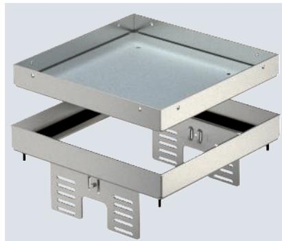
Nivellierbare und vom Fußboden entkoppelte Kassette "blind" für die Herstellung einer Revisionsöffnung der Nenngröße 4 in trocken oder nass gepflegten Fußböden im Innenbereich, zur Montage in Unterflurdosen UZD250-3 oder UZD350-3, jeweils in Verbindung mit einem Montagedeckel DUG../4 oder in UGD250-3/4 oder UGD350-3/4. Die Montage erfolgt mittels Nivellierwinkel (separat bestellen) im Aluminium-Rahmenprofil der Unterflurdosen. Nur für glatte Bodenbeläge geeignet.
