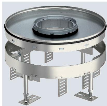
Runde Kassette Schwerlast für Tubus in Nenngröße R7 für den Einbau von Installationsgeräten in Kanalsystemen, Doppel- und Hohlböden, in trocken oder nass gepflegten Fußböden im Innenbereich. Belastungsklasse 2 bis 20 kN.
