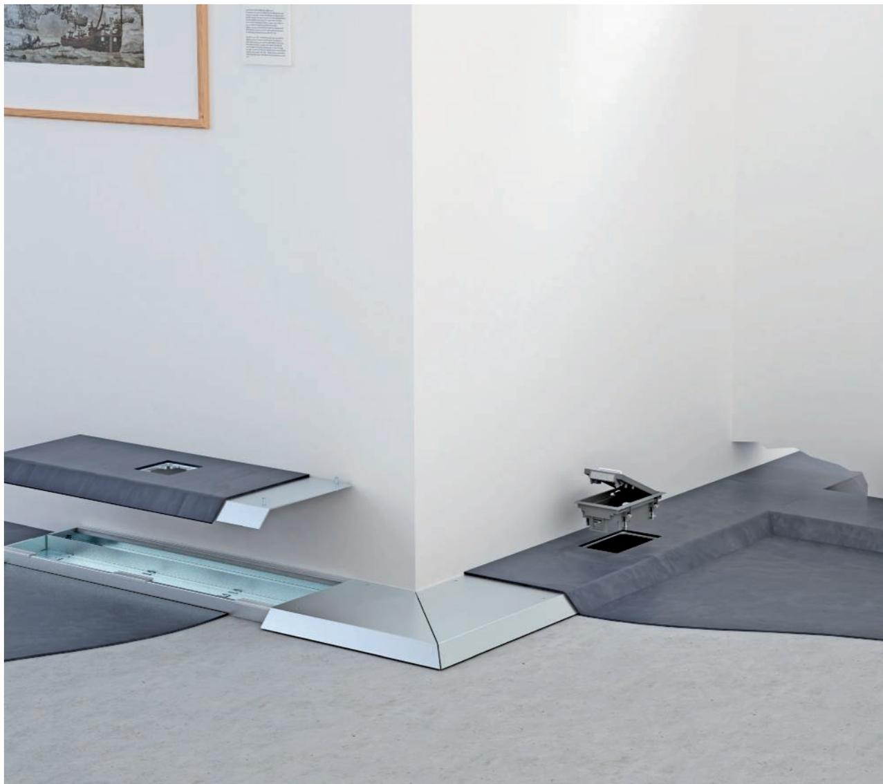
Das Auflur-Kanalsystem AIK wird auf dem fertigen Fußboden installiert. Das System kommt insbesondere dort zum Einsatz, wo klassische Unterflur-Systeme nicht installiert werden können: bei der Gebäudesanierung, vor
