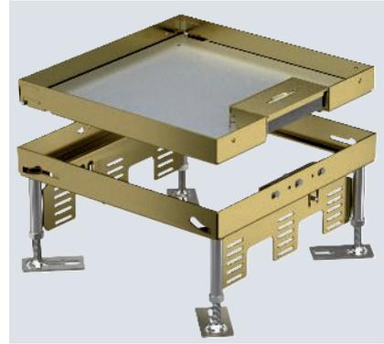
Nivellierbare Kasette der Nenngröße 9 mit Schnurauslass für den Einbau von Installationsgeräten in trocken gepflegten Fußböden im Innenbereich.
