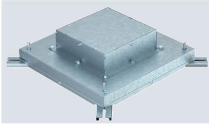
Im-Beton-Dose für Kanalhöhe 48 mm vorbereitet für Kanalbreiten 250 und 350 mm. Mit vier verstellbaren Aufnahmen für Nivelliereinheiten. Der integrierte Schalkörper kann für ausgleichende Estricharbeiten bis maximal 65 mm verstellt werden.
