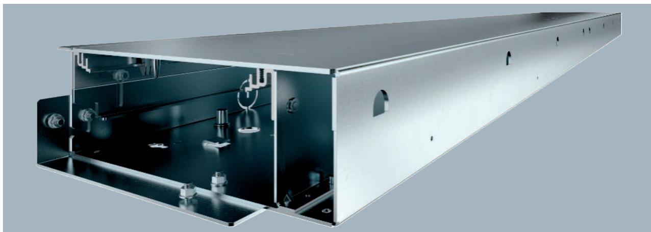
Montagefertige Kanaleinheit zur Leitungsführung und zum Geräteeinbau, bestehend aus einem Kanalunterteil mit zwei Blinddeckeln und zwei verstellbaren Bodenbelaganlegeprofilen zur Estrichabgrenzung in Bereichen von Türschwelen und vor Heizkörpernischen. Im Lieferumfang enthalten sind zwei Deckelstoßdichtungen und ein Verbinder. Zur Höheneinstellung werden sechs Nivelliereinheiten benötigt.
