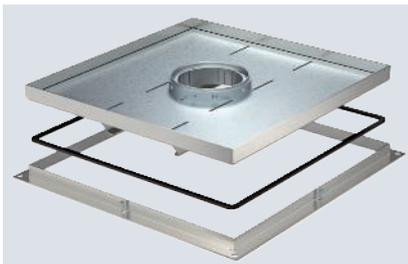
Rahmenkassette Schwerlast für Tubus für den Einbau von Installationsgeräten in der UZD350-3 in trocken oder nass gepflegten Fußböden im Innenbereich. Belastungsklasse 1 bis 10 kN.
