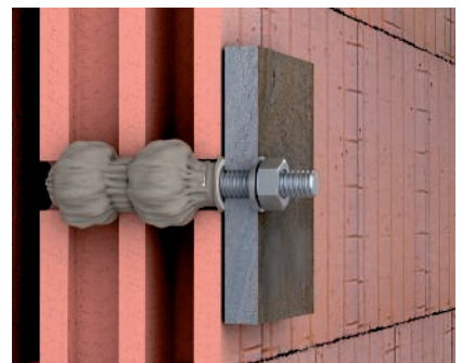
Montiertes Bauteil, Wand aus Hohllochziegel Montieren des Bauteils mit Scheibe und Mutter an einer Wand aus Hochlochziegel. Dazu das Anzugsdrehmoment gemäß Zulassung beachten.
