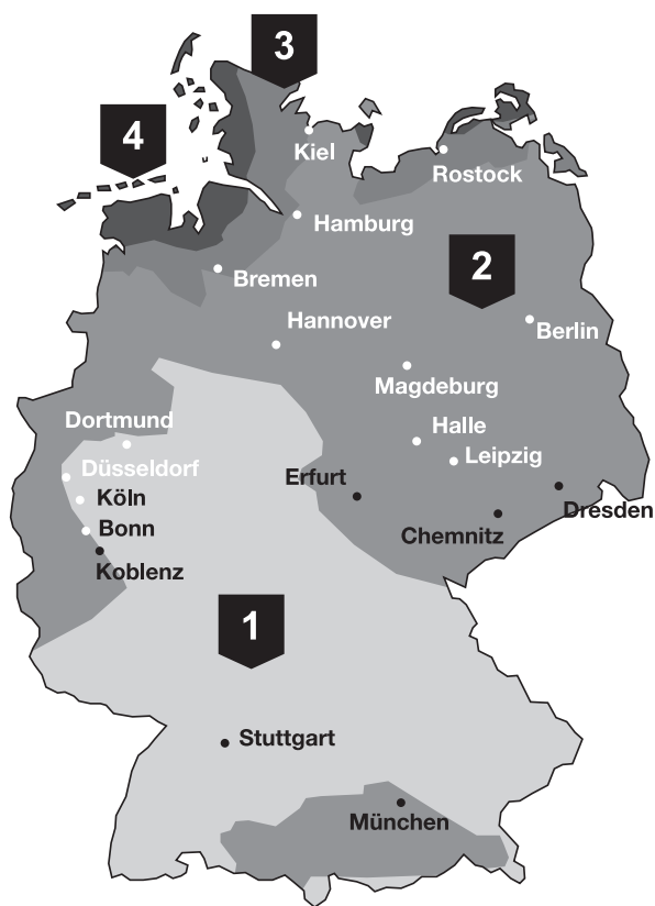
Bild 1: Windzonen in Deutschland nach DIN EN 1991-1-4 NA
