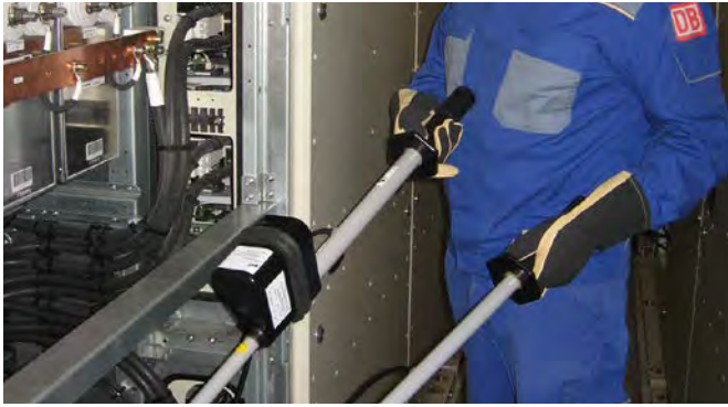
Gleichspannungsprüfer PHE/G II für Gleichstromzwischenkreise (ICE-Triebkopf).
