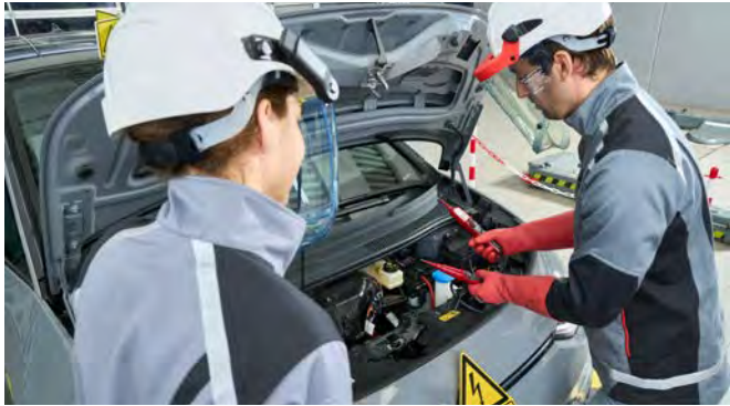
Prüfung der hohen DC-Spannung eines HV-Elektrofahrzeuges.
