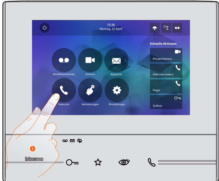
1. Berühren, um den Abschnitt Intercom abzurufen.
