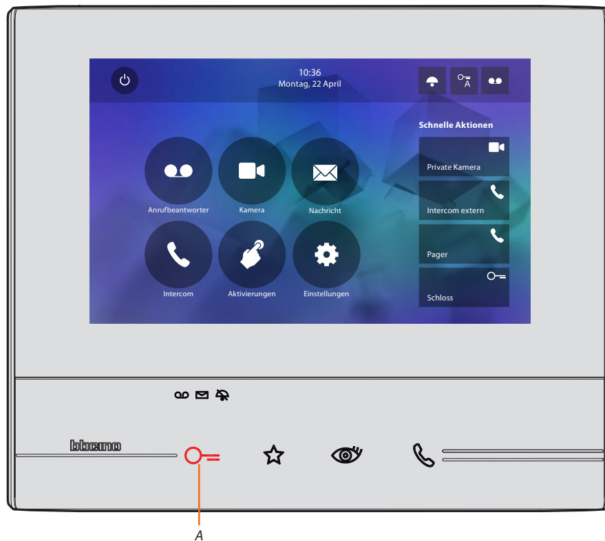
A. Blinkende LED = Schloss geöffnet
