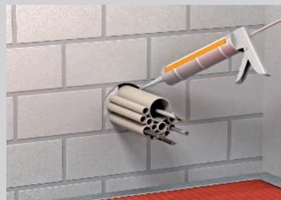
Verschließen der Ringspalte mit Dämmschichtbildner DSX.
