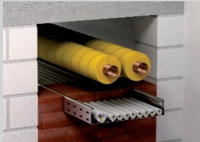
Durchgeführte nicht brennbare Rohre mit Streckenisolierung.
