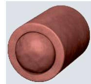
Rohrschale für Kabelschott bestehend aus einer einteiligen, harten Rohrhülse und zwei weichen Stopfen mit 50 mm Durchmesser. Rohrhülse und Stopfen vor Wasser schützen, um ein sicheres Aufschäumen im Brandfall zu garantieren.
