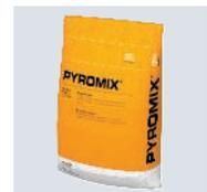
Mörtel zum Erstellen von Kabel- und Kombiabschottungen in massiven Wänden und Decken. Geeignet zum Pumpen, Pressen und zum Handeinbau. 20 kg Trockenmörtel ergeben bei Zugabe von ca. 6 Litern Wasser etwa 20 Liter verarbeitungsfähige Masse.
