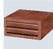
Kasten für Kabelschott. Bestehend aus einem zweiteiligen, harten Rahmen und zwei weichen Innenstücken. Rahmen und Innenstücke vor Wasser schützen, um ein sicheres Aufschäumen im Brandfall zu garantieren.
