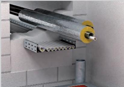
Elektroinstallationsrohre aus Stahl ebenfalls mit Streckenisolierungen versehen.
