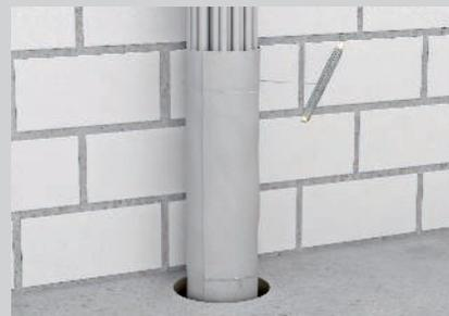
Fixieren der Bandage mittels Wickeldraht.
