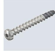
Edelstahl-Schraubanker zur direkten Montage ohne Dübel in gerissenem und ungerissenem Beton sowie Mauerwerk. Mit Rundkopf für universelle Befestigungen in Feuchträumen und Außenbereichen. Toxx-Antrieb T30. Gemäß EAD geprüft, CE-gekennzeichnetes Bauprodukt mit Europäischer Technischer Bewertung (ETA) und Anwendbarkeitsnachweis. Tragfähigkeiten unter Brandbelastung bis zur Feuerwiderstandsklasse R120 nachgewiesen.
