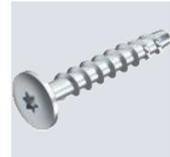
Schraubanker zur direkten Montage ohne Dübel in gerissenem und ungerissenem Beton sowie Mauerwerk. Mit großem Rundkopf für die Befestigung von Montage- und Profilschienen. Torx-Antrieb T30. Gemäß EAD geprüfetes, CE-gekennzeichnetes Bauprodukt mit Europäisch Technischer Bewertung (ETA) und Anwendbarkeitsnachweis. Tragfähigkeiten unter Brandbelastung bis zur Feuerwiderstandsklasse R120 nachgewiesen.
